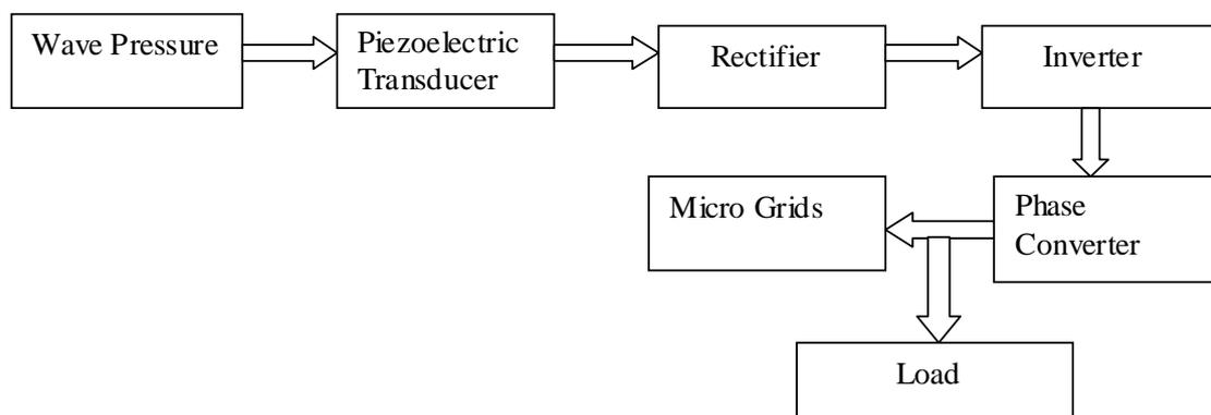
(Fig-3.1.1-Process flow diagram)
