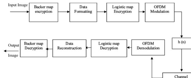
Fig. 2: System Diagram
